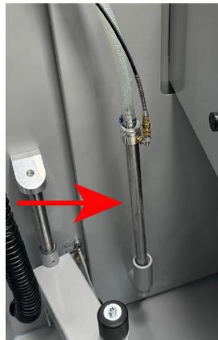
Fig. 18: Lanza de aspiración/fluidización
