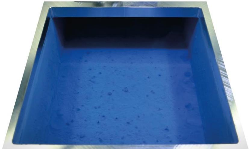
Fig. 12: Ejemplo – Fluidización óptima del polvo en el OptiSpeeder
