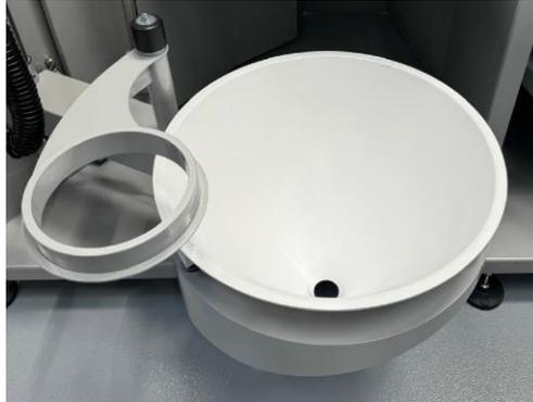
*Fig. 19: Embudo del saco de polvo completo*
