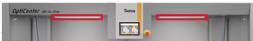
Fig. 8: Lugar de montaje de las luces de estado
