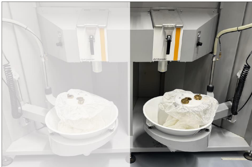
Fig. 97: Collocazione di polvere fresca area di lavoro 2
