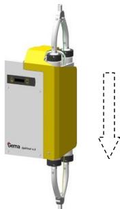
Die Nachförderung vermeidet, dass sich das Pulver im Schlauch ablegen und diesen verstopfen kann. Bei aktivierter Nachförderung wird nach dem Beenden des Pumpprozesses um einige vordefinierte Zyklen weitergefördert, ohne Pulver anzusaugen (empfohlen bei Pulverschlauchlängen von über 2 m). Die Nachförderung ist ab Werk aktiviert.
