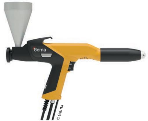
Der integrierte Injektor wird mit einem Handgriff entfernt und gibt den Blick durch die gradlinige Pulverführung frei. So können Pulverrohr und Injektor mit einem Blick auf Sauberkeit geprüft werden.
