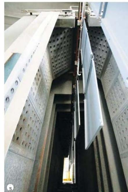
Photo 3: pièces entrant dans le tunnel de prétraitement en 5 étapes
