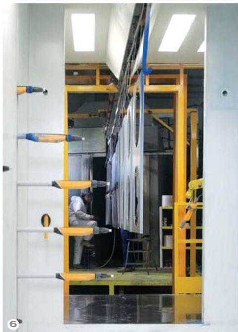
**Figure 6: Le réciprocatriceur dynamique en fonctionnement**
