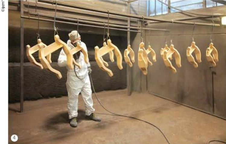
Photo 4: Etape de l'application liquide dans la cabine statique
