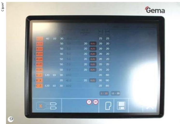
Photo 9: Le panneau de commande de la cabine de poudrage.
