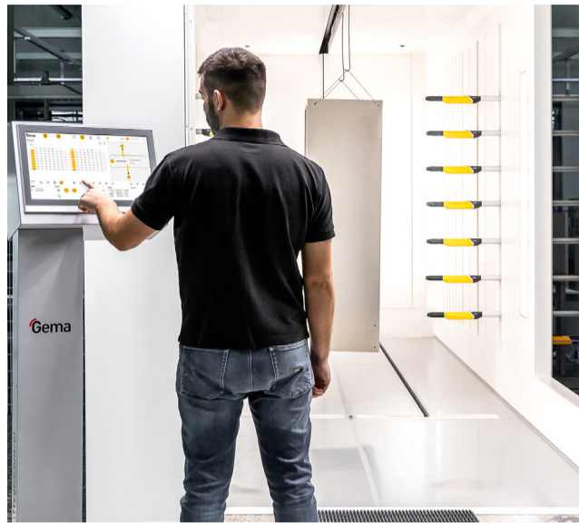
Die neue Steuerlösung lässt sich flexibel in eine freistehende Säule oder in einen Steuerschrank integrieren.
