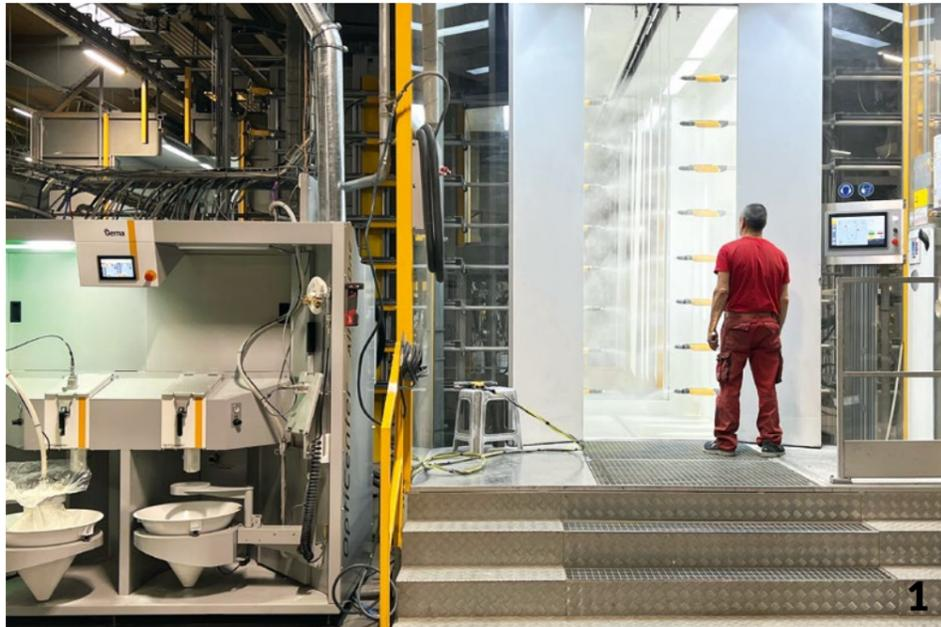
**1:** Mit dem neuen Pulvermanagement verdoppelt sich die Effizienz und ultraschnelle Farbwechsel werden möglich.
