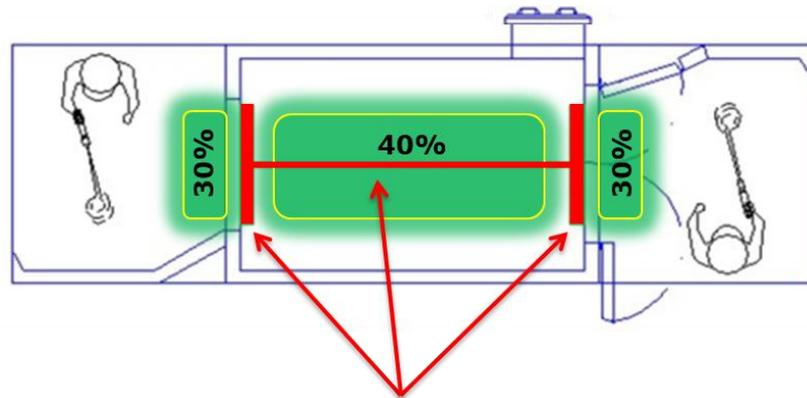
Schlitze in Kabinenboden für Absaugluft
