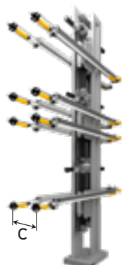
Montaje máximo: hasta tres módulos ZA17 cada uno encima del otro a ambos lados del ZS05 con una distancia entre pistolas de 350 mm (C)
