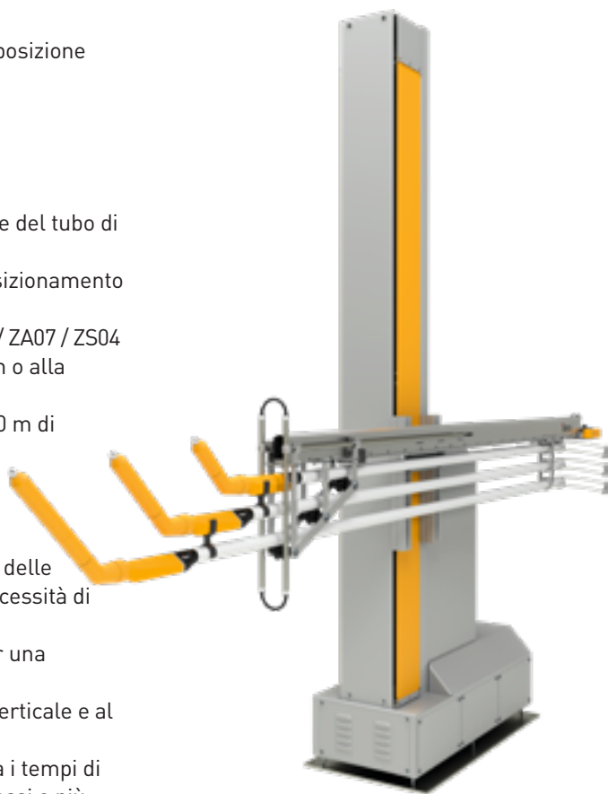
Asse multi-pistola UA05-3 con 3 pistole e anello di soffiaggio
