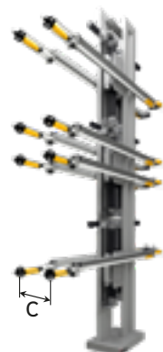
Maximalbestückung - bis zu drei ZA17 Module übereinander auf beiden Seiten der ZS05 mit 350 mm Pistolenabstand (C)
