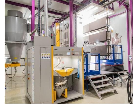
Besonders beeindruckend sind die Sauberkeit der Beschichtung und der hohe Automationsgrad. Das Ziel «1 Programm für alle Teile» konnte praktisch von Beginn weg umgesetzt werden. Mit den zwei Nachbeschichtungsstationen auf Hebebühnen arbeitet WOB sehr flexibel, erzielt beste Beschichtungsqualitäten und schnelleren Durchlauf. Zudem konnte die Nachbearbeitung der komplexen Teilevielfalt massiv reduziert werden.
