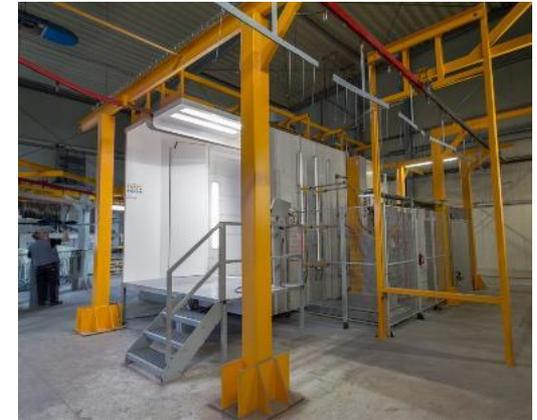
Herausforderung. Die neue Anlage nutzt perfekt jeden Millimeter Platz in der Halle aus, was den Fachleuten bei JO-BA ergonomische Abläufe ermöglicht. Zusammen mit der neuen Applikation überzeugen die Resultate. Farbwechsel dauern noch gut 15 Minuten und die Anlage läuft vollumfänglich auf Rückgewinnung, ohne Verlust. Zusammen mit dem hohen Auftragswirkungsgrad der Pulverpistolen werden bis zu 1 kg Pulver pro Container eingespart.
