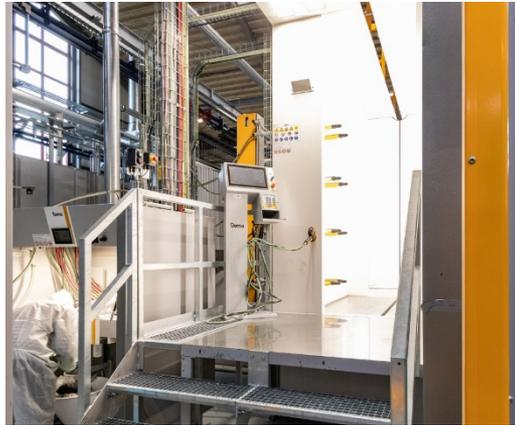
Applikationstechnik und Kabinentechnik installiert. Um ein möglichst grosses Teilespektrum zu beschichten, verfügt das Gemma Farbwechselsystem EquiFlow über besonders grosse Öffnungen. Erstmals kam an der Anlage von Helling & Neuhaus das OptiCenter OC08 mit Injektoren zum Einsatz. In Verbindung mit der CM40 Steuerung bietet die neue Beschichtungsanlage einen sehr hohen Automationsgrad.
