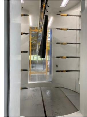
Das neue, kompakte MagicCylinder EquiFlow QCS04 Kabinensystem hat den Automatisierungsgrad erhöht und ermöglicht schnelle, saubere Farbwechsel. Dank der AP01.1 Applikationspumpen erzielt HMP höchste Qualitätsstandards mit allen Pulverlacken. Durch den parallelen Betrieb wurde die Kapazität um das Doppelte gesteigert. Der hohe Automationsgrad der neuen Anlage sichert HMP zudem Prozesssicherheit sowie Flexibilität in der Abwicklung der Kundenaufträge.
