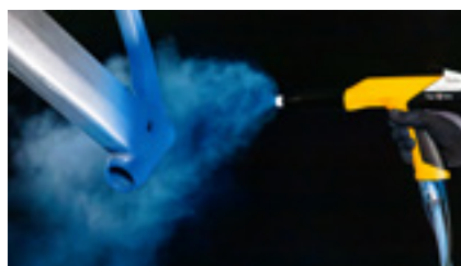
1 Ajuste automático de parámetros en tiempo real alrededor de la geometría compleja
