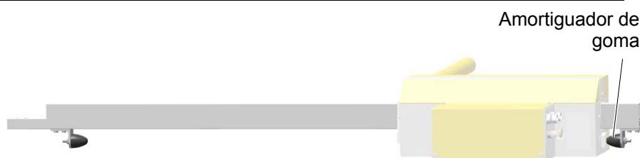
Eje de pistola UA03: punto de referencia y topes mecánicos
