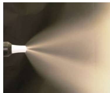
volumen excesivo de aire de limpieza del electrodo
