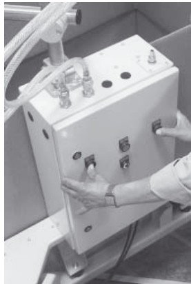
Abb. 4.4 Stopp-Drucktaster für Horizontallage
