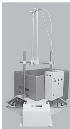
Abb. 4.1 Kipptisch mit Fluid-/Ansaugereinheitposition oben
