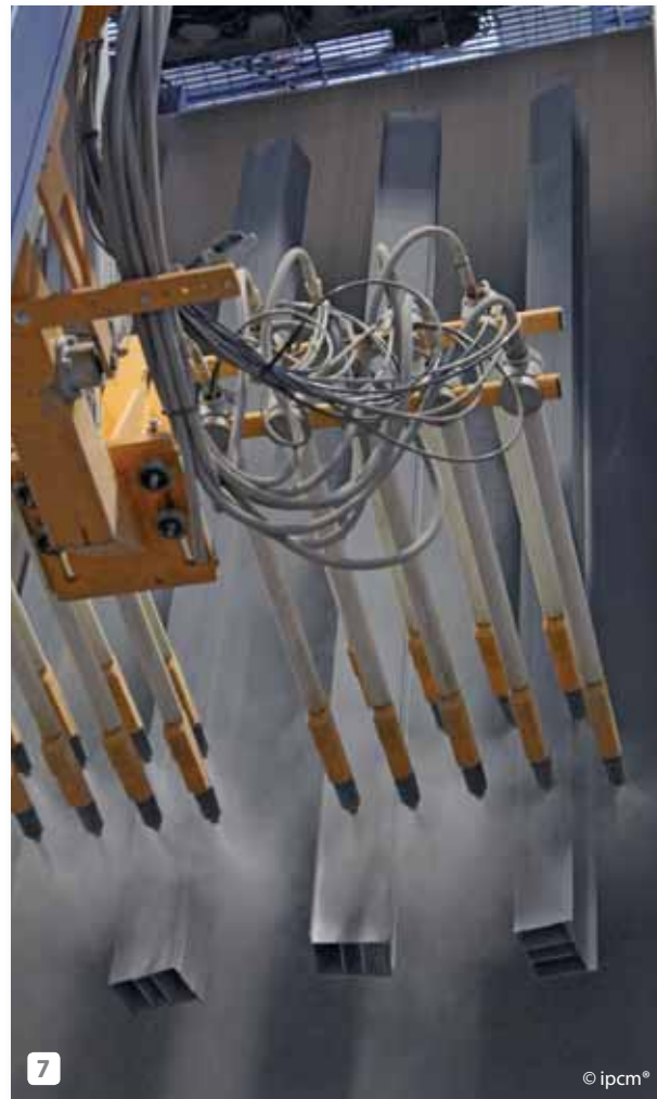
7 The powder application stage in one of the two vertical booths. La fase d'applicazione delle polveri in una delle due cabine verticali.
