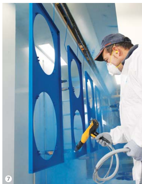
Figura 7: Post-ritocco delle aree di difficile penetrazione.
