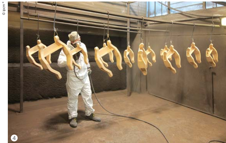
Figura 4: Applicazione nella cabina statica di verniciatura a liquido.
