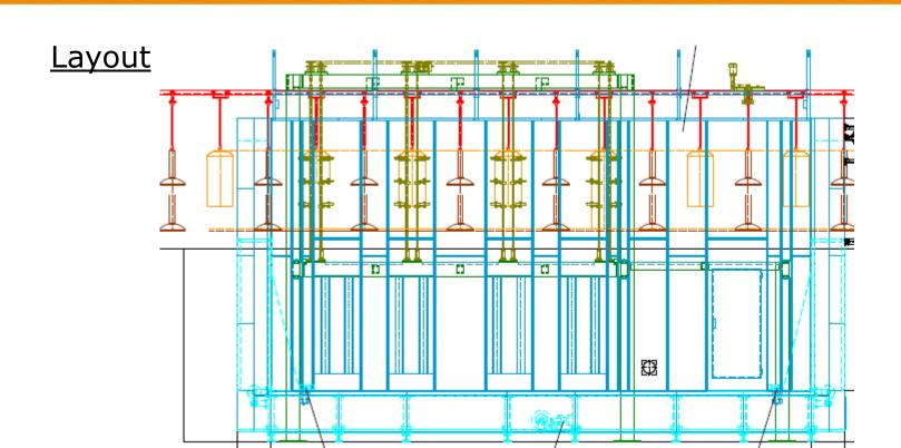
4 Stations «Boiler inside coating» / 1 Station «Pipe coating»
