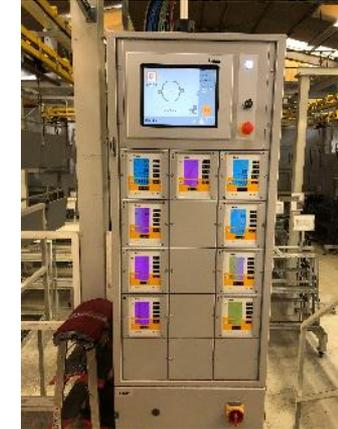
Systemsteuerung CM30. Das moderne Applikationssystem wurde mit dem zuverlässigen und noch gut funktionierenden Pulverkreislauf auf kleinstem Raum kombiniert. Frisch- und Kreislaufpulver werden weiterhin über das bestehende, im Monozyklon integrierte, Ultraschall-Sieb dosiert.
