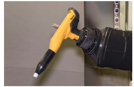
Bild 1: Pistole mit winkliger Versetzung zur Anbindung am Roboterarm
