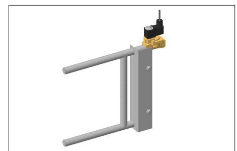
Bild 12: Aussenabreinigungsstation für die Pistole
