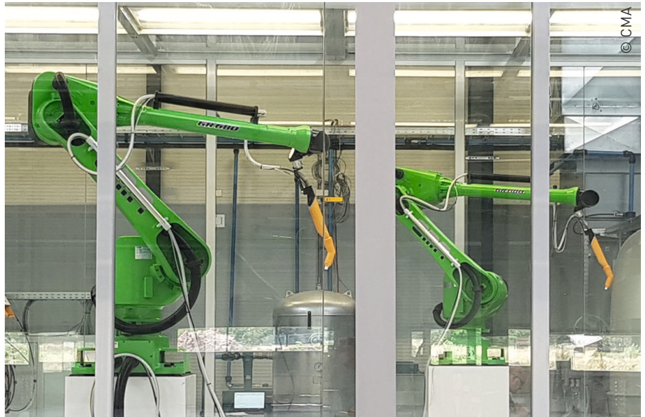
Bild 25: CMA Roboter für die Pulverbeschichtung
