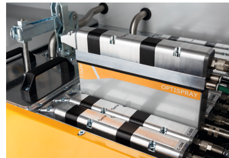
Bild 5: OptiSpray Dichtstromfördertechnologie für die höchsten Ansprüche und konstante Beschichtungsergebnisse
